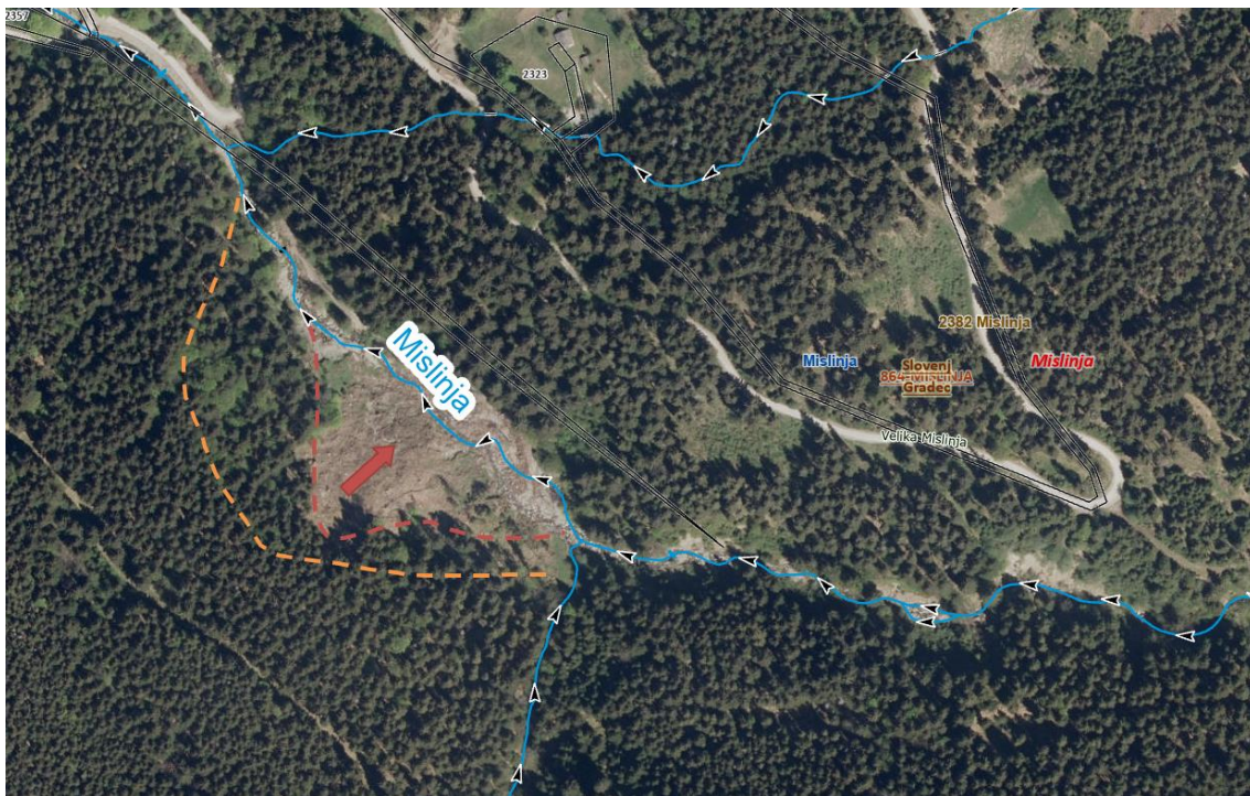
Slika 2: Pogled na lokacijo splazitve – po Ujmi 2023 (Vir: Atlas voda). Rdeča barva prikazuje območje splazitve po Ujmi 2023, oranžna barva pa območje potencialne splazitve, v kolikor se ne izvedejo.
